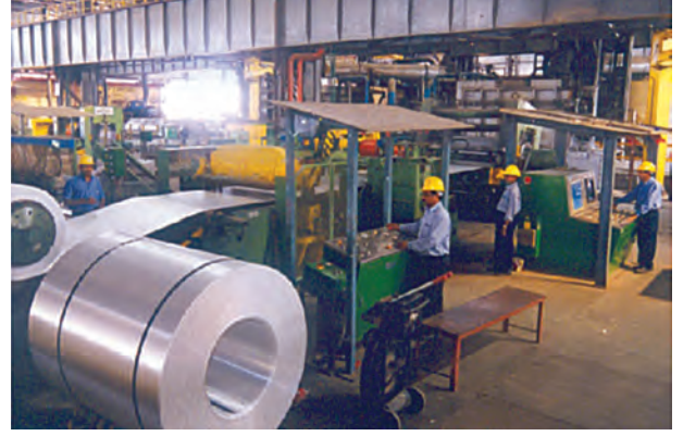
चित्र 6.6 – नाल्को प्रगालक में पट्टी लेप मिल
